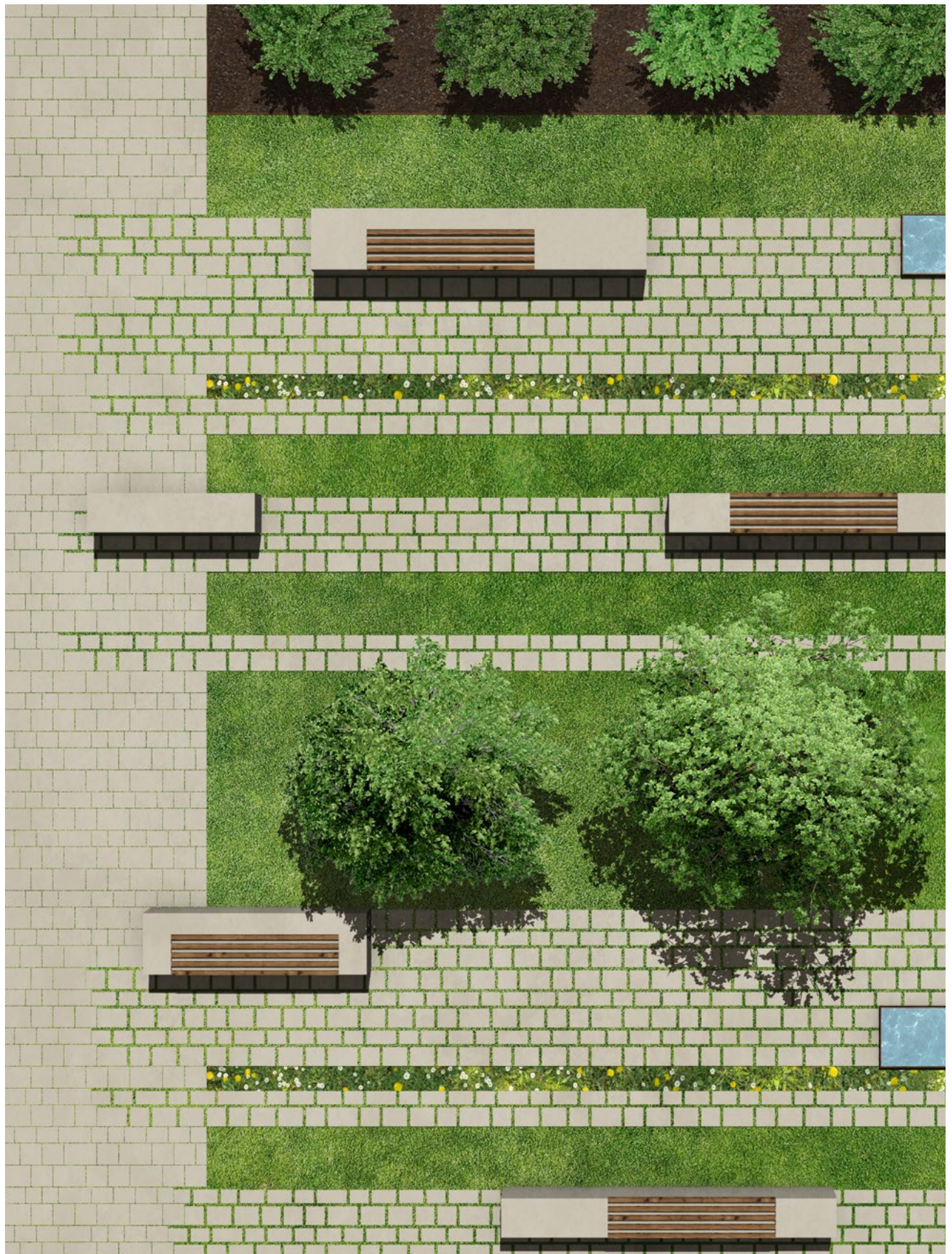
Schwammstadt Variante 3.2: Mehrsteinsystem Typ AH und Typ AI 30 mm gap, Reihenverband
