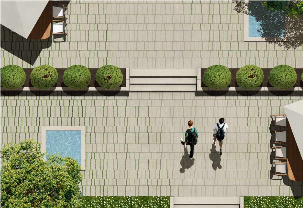
Schwammstadt Variante 4.1: Mehrsteinsystem Typ AD, Typ AD 13 mm liner 1-1 und Typ AD 26 mm liner 1-1, Reihenverband Hochkant
