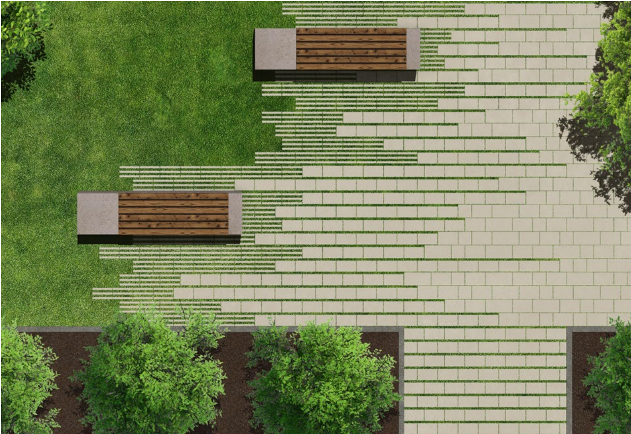
Schwammstadt Variante 2.1: GDM.TETRAGO liner 1-1 30/20/10 cm, liner 3-3 30/20/10 cm und Mehrsteinsystem Typ BJ, Reihenverband
