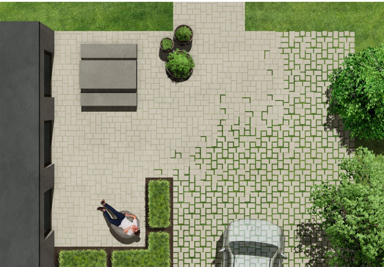
Schwammstadt Variante 1.1: Mehrsteinsystem Typ BJ, GDM.TETRAGO gap 30/20/8 und 20/20/8 cm, ungerichteter Verband
