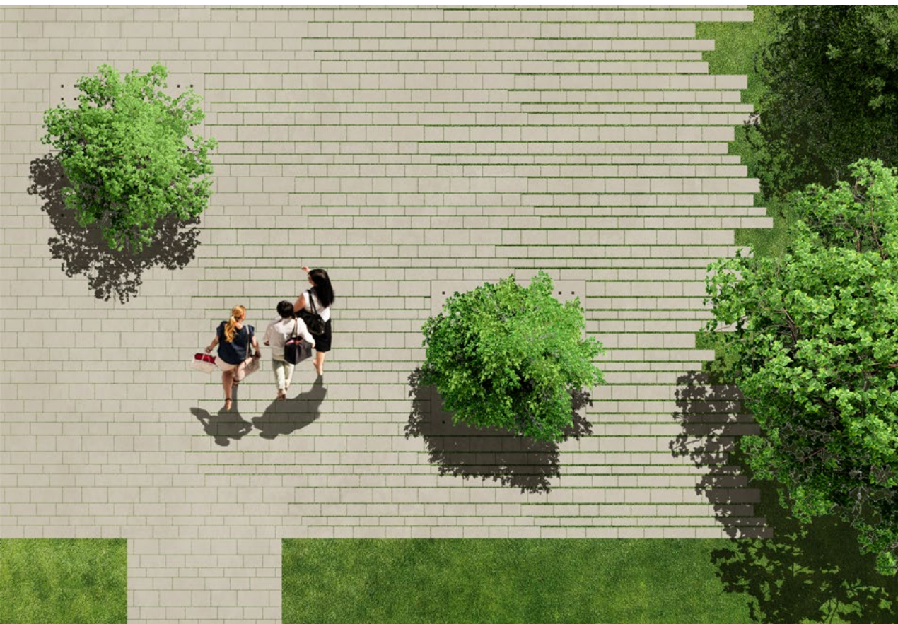
Schwammstadt Variante 4.2: Mehrsteinsystem Typ AD, Typ AD 13 mm liner 1-1 und Typ AD 26 mm liner 1-1, Reihenverband
